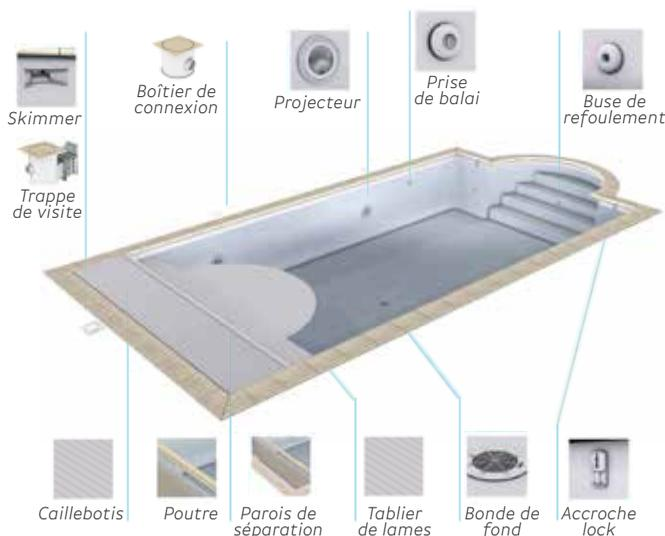
Il est impératif que les descentes de skimmer soient réalisées en tuyau rigide jusqu'en fond de fouilles. **Conforme à la norme NF EN 16 713-2.**
