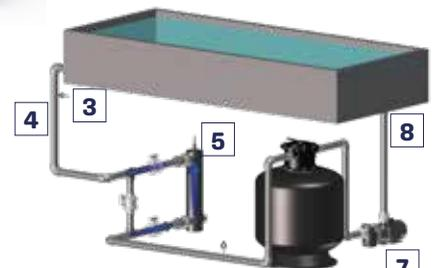
1. Piscine 2. Refoulement 3. Injection pH 4. Sonde pH
